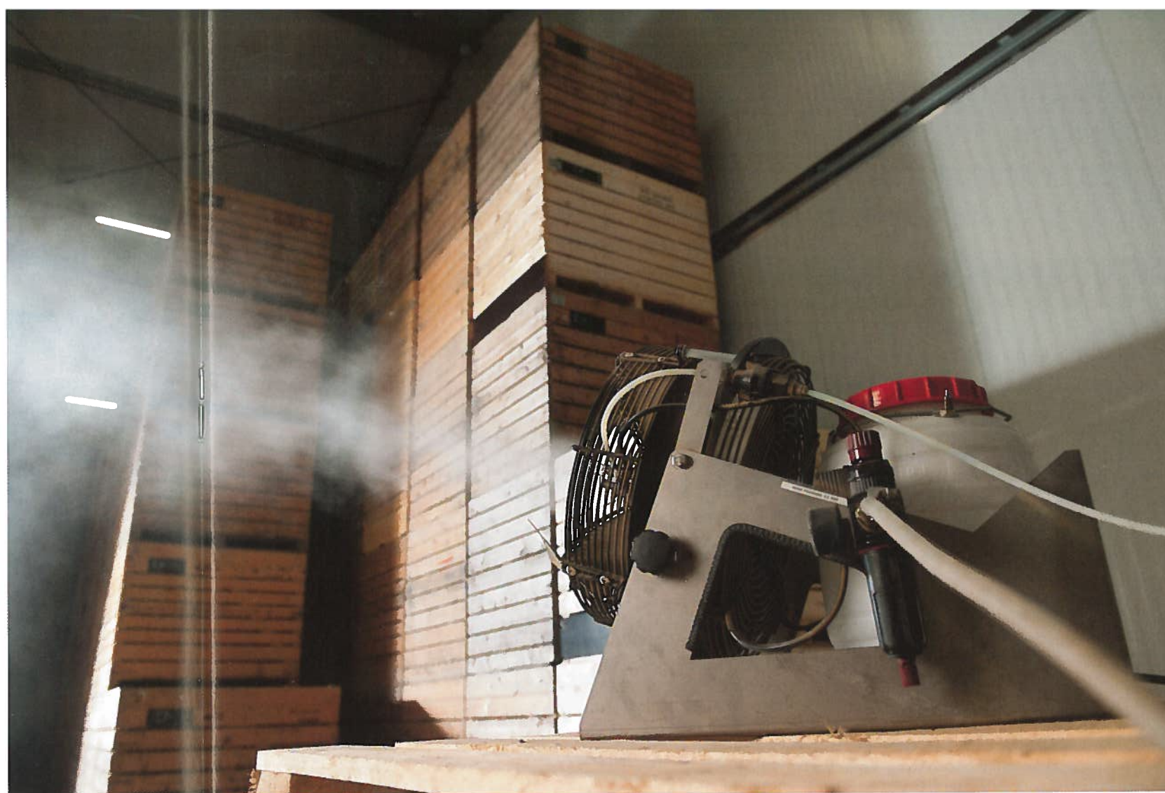
De Coldfog Resonator-koudvernevelaar in een proefopstelling. De machine produceert het fijnste druppelspectrum van alle beschikbare apparatuur. FOTO'S: MARK PASVEER
